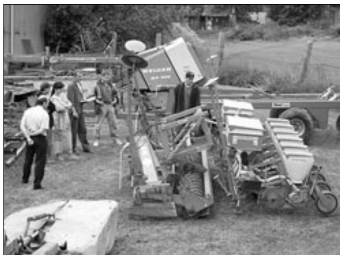
Žák Jan Boubín vysvětluje zařazení secí kombinace – rotační brány a přesný secí stroj v technologii pěstování kukuřice
